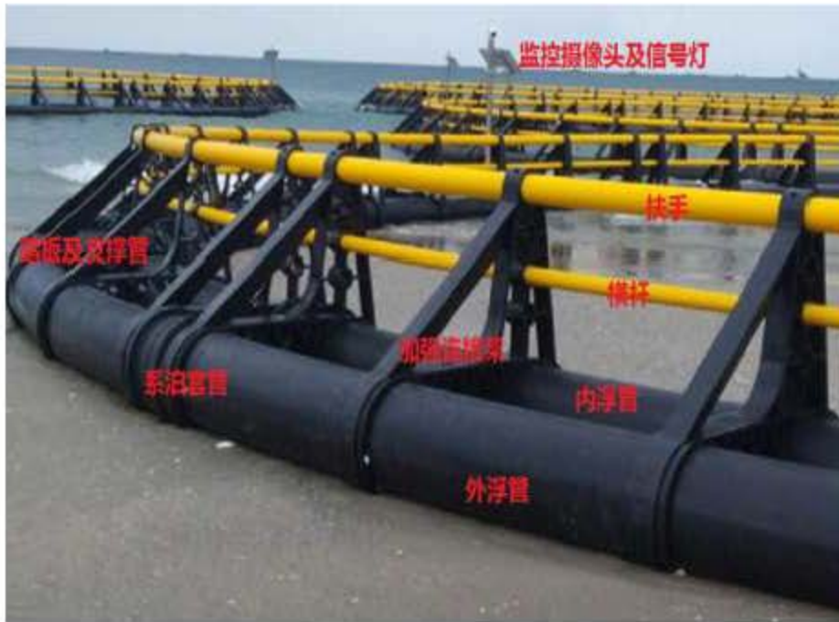
图 3.4.1-3 加强型网箱浮架的主要部件示意图
