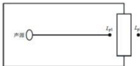
图 4-1 室内声源等效为室外声源图例
