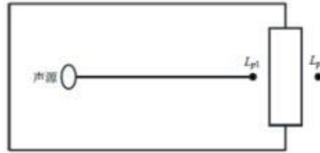
图 4-1 室内声源等效为室外声源图例
