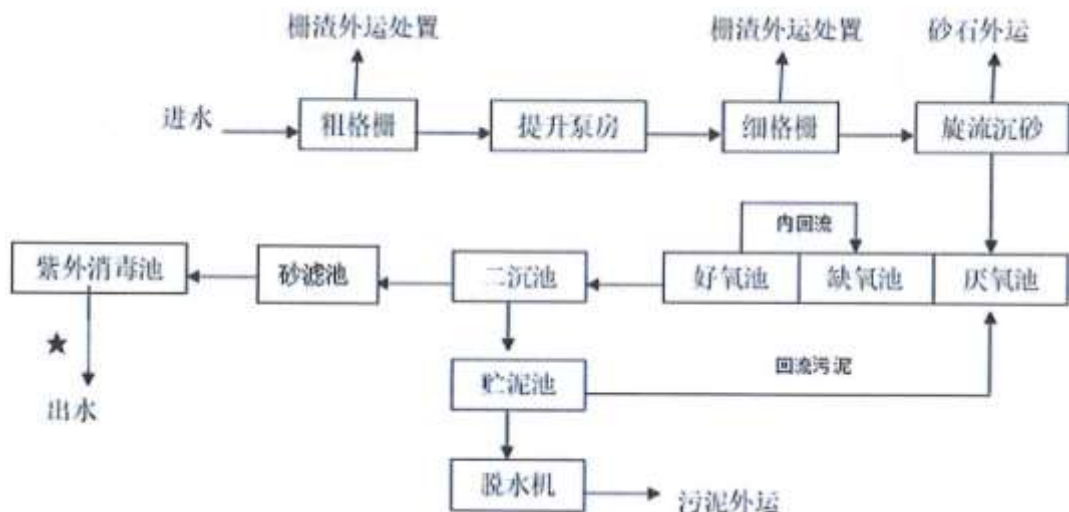
图 4-1 污水处理厂工艺流程
