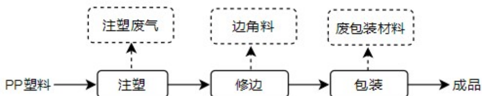
图 2-5 项目塑料配件工艺流程及产污节点图
