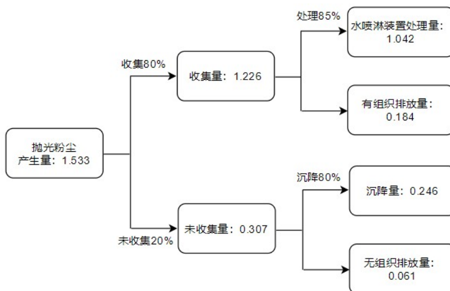
图 4-2 抛光粉尘处理流程示意图 (t/a)
