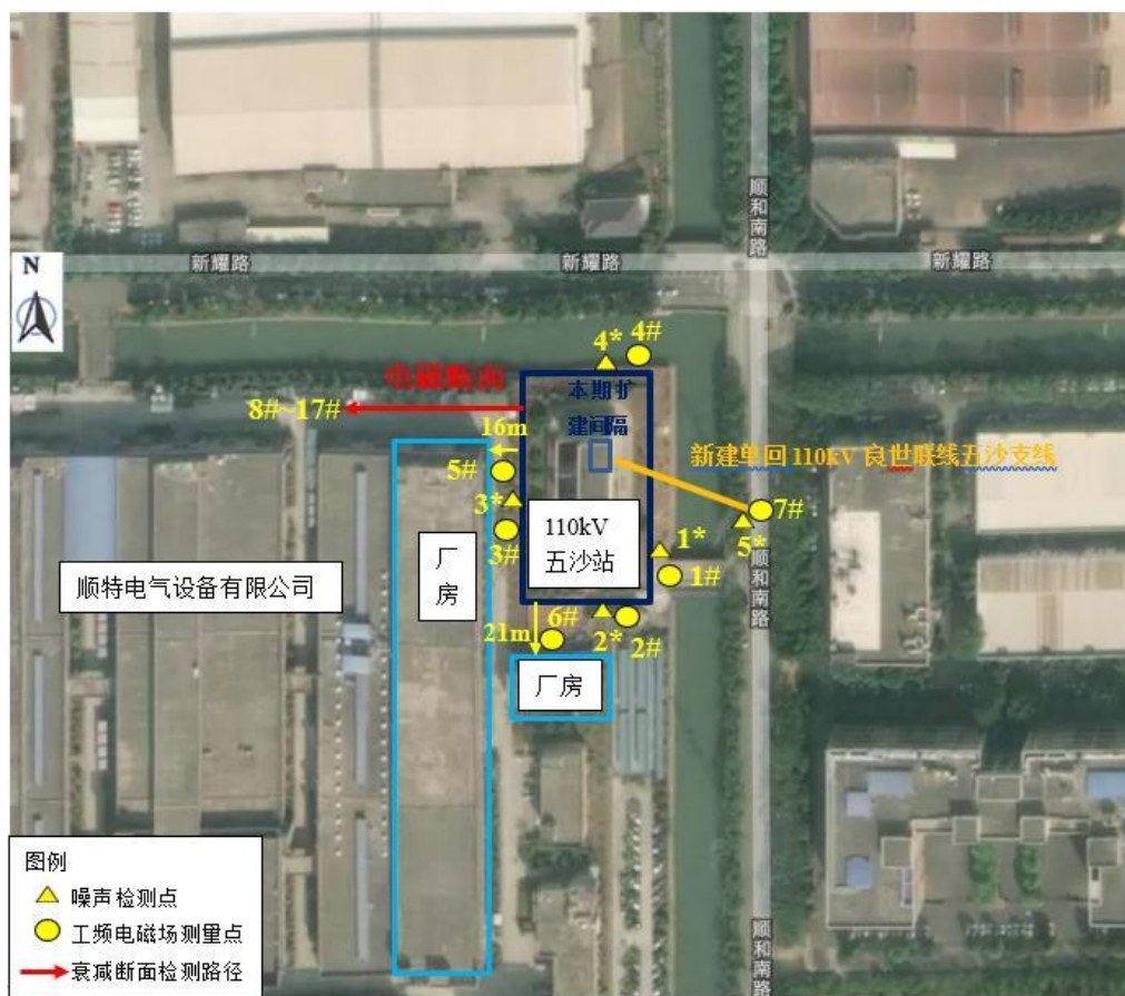
图 1 110kV 五沙变电站类比监测布点图
